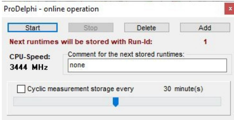
kann die Zeitmessung gestartet oder gestoppt werden. Dies ermöglicht es Ihnen, nur bestimmte Aktivitäten des Programms zu messen. Der 'Start'-Button aktiviert die Messung, der 'Stop'-Button deaktiviert sie. Mit dem 'Delete'-Button werden alle Zähler auf Null gesetzt. Der 'Add'-Button speichert die aktuellen Zählerstände in der Ergebnisdatei und setzt die Zähler auf Null.
